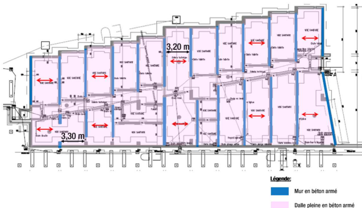
Figure 10: Système constructif du vide sanitaire
